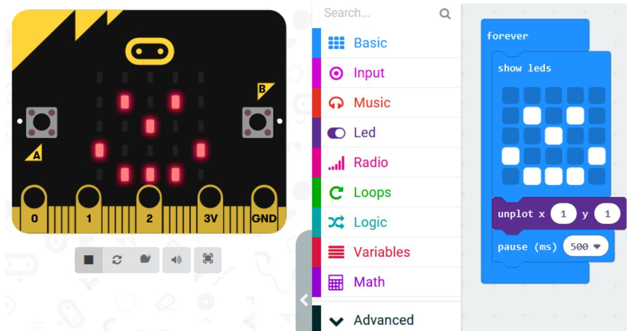
Prikaz virtualnog micro:bita nakon pola sekunde
