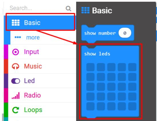
Postavite **show leds** na dio za programiranje te nacrtajte smješka.
