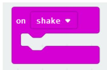
Sve naredbe koje stavimo unutar **on shake** naredbe pokrenut će se onda kada protresemo micro:bit.
